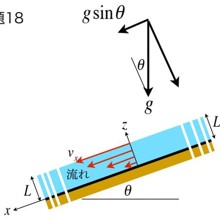
ここではまだ基礎方程式の使い方を習熟していないが、普通のデカルト座標で斜面に沿う方向をx, 斜面に垂直方向をzとする。流れはx成分のみで重力によって生じる流れは図のように分布し、運動量は斜面の方向に移動し、斜面表面に粘性まきつ力を与えている。重力とこの摩擦力の反作用はバランスしており、流れは定常状態となっている。定常なので、液膜の厚さ(高さ)はLで一定となっている。直角座標、運動の式のx成分の式で、粘性力と重力のバランスを考えると、
