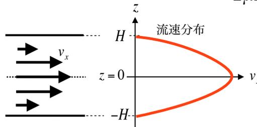
$z=0$ の対称面で流速は最も大きく, 静止している平板に接触している流体の流速はゼロ
