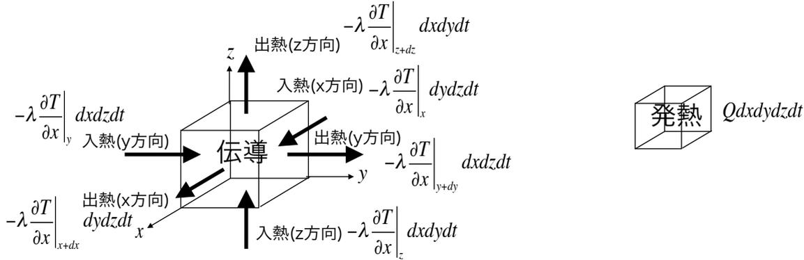
直角座標のCVのdt時間での熱量収支
