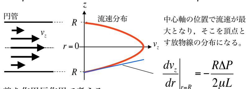
解を検証する：壁面に作用する力，圧力差を作用反作用で考える
