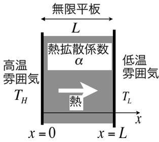
左のような無限平板（縦方向に無限に広がっている）の両側がそれぞれ、高温と低温で保持されている。熱は平板内を高温面(x=0)から低温面(x=L)に伝導のみで移動する。
