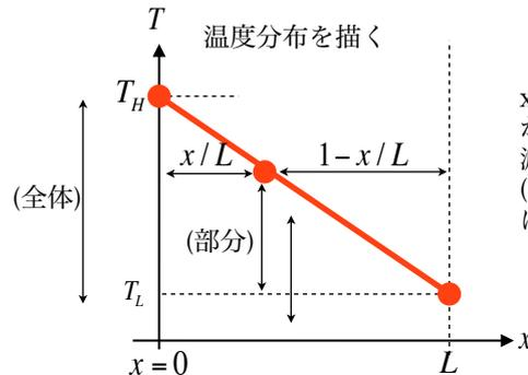
xの増加に伴ってT<sub>H</sub>からT<sub>L</sub>に直線的に減少する分布。(部分)に相当するのは1-x/Lである。
