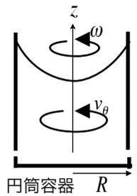
速度分布：運動の式，円筒容器，軸対象：円筒座標， $\theta$ 成分
