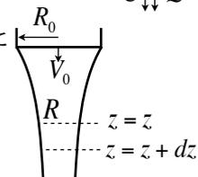
図に示す微小区間で液体の体積収支を考えることによって, 液体の半径 $R$ を $z$ の関数として導出して下さい。また, 連続の式を適用することで, 半径方向の流速を $r$ ,  $z$ の関数として導出して下さい。
