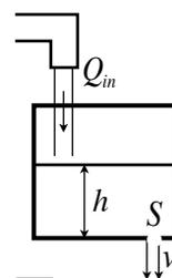
問題12 水槽に一定の量 $Q(\ell/s)$ で水が入り, 同じ水量で出ている。入る水には一定の濃度 $C_i(g/\ell)$ でインクが混入している。インクは水槽内で素早く広がり, 常に均一の濃度 $C(g/\ell)$ になっていると考えよう。水槽内の水の体積を $V(\ell)$ として, 水槽内にインクを入れ始めてからの濃度 $C$ の変化を示す式を導出しなさい。さらに,  $C_i = 0.55 g/\ell$ ,  $V = 110 \ell$ ,  $Q = 0.15 \ell/s$ として, 水槽内の濃度 $C$ が $0.30 g/\ell$ になるまでの時間を計算しなさい。
