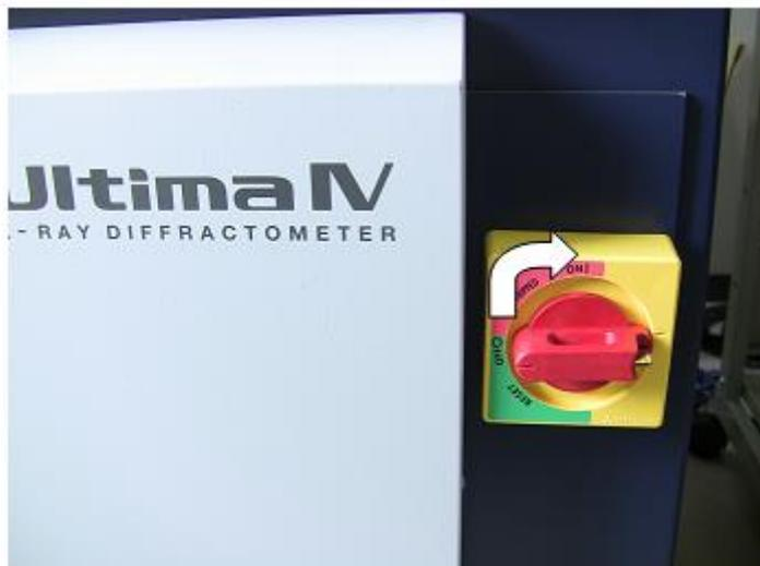
図4 装置本体の電源レバー
