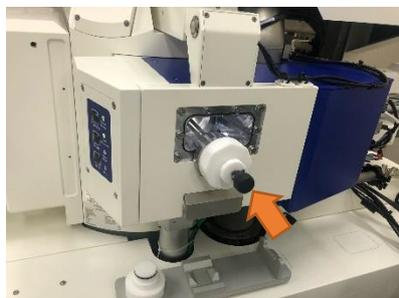
図 2-j 試料棒挿入
